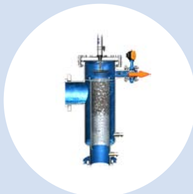
Nettoyage phase 1 Le nettoyage est enclenché par horloge ou contrôle de pression différentielle. La vanne de chasse s'ouvre et les plus grosses particules sont évacuées.
