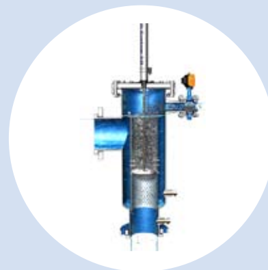
Nettoyage phase 2 Le piston effectue deux courses à l'intérieur du panier, décrochant les particules qui sont simultanément évacuées.
